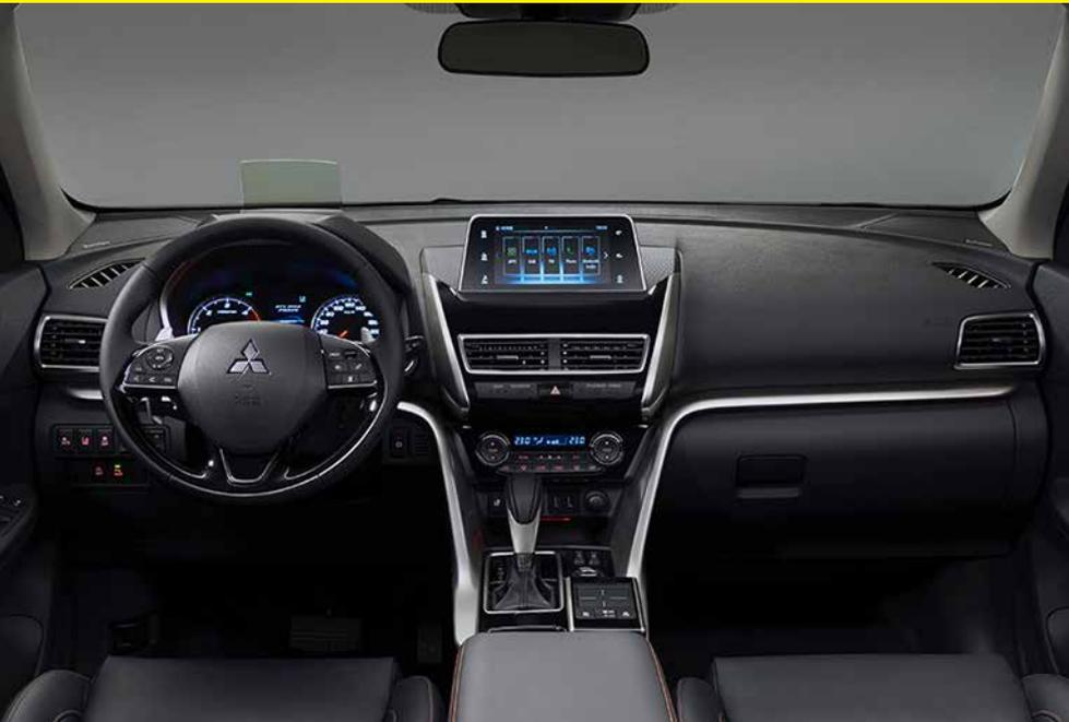
So beinhaltet die Ausstattung etwa das Infotainment-System Smartphone Link Display Audio/ SDA und eine Touchpad-Steuerung. Die einfache Positionierung des Touchpads in der Mittelkonsole ermöglicht eine ergonomische Bedienung des Infotainment-Systems.
